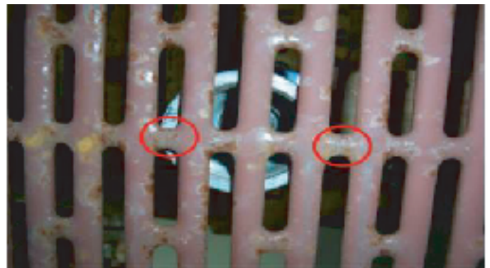
SCHONLAU (GERMAN CAST), 1594 LBF: FAILURE
